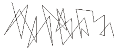
Dráha elektronu ve vodiči připojeném k elektrickému napětí – uspořádaný pohyb
